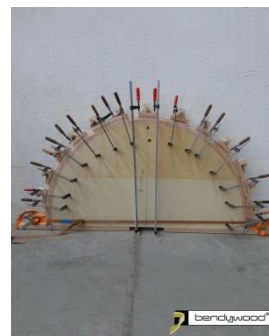
Dima per piegare un profilo ø60 mm tagliato a metà
